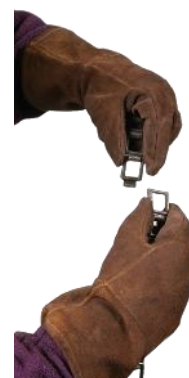
Schalmen kunnen eenvoudig aangebracht en verwijderd worden voor de verschillende pijp-Ø.
