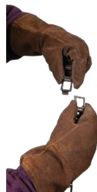
Les maillons de chaîne peuvent être facilement ajustés en fonction de divers diamètres de tube.
