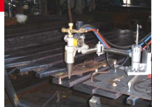
IK-82 M300 beim Schneiden von Profilen
