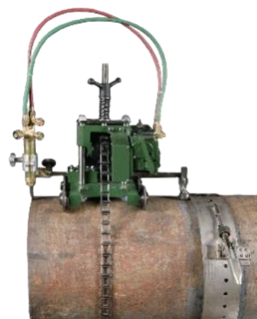
Il binario di guida opzionale permette una elevata precisione di taglio, particolarmente adatta per tubi di grandi dimensioni. Ciascun binario di guida è dotata di maglie di catena aggiuntive per ciascun diametro del tubo.
